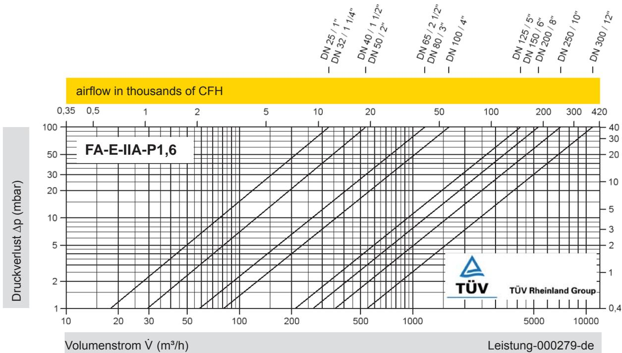
Diese Volumenstromdiagramme sind mit einer kalibrierten und TÜV-zertifizierten Strömungsmessanlage ermittelt worden.
