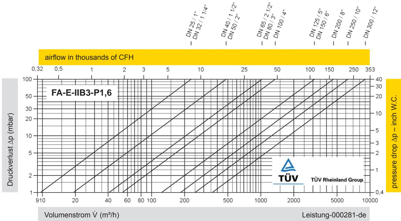
Diese Volumenstromdiagramme sind mit einer kalibrierten und TÜV-zertifizierten Strömungsmessanlage ermittelt worden.
